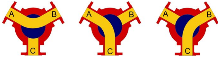
Bild 2 Schema Schaltfunktionen BR29a, 3-Wege Molchweiche
