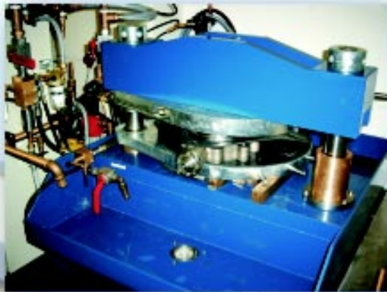
Prüfstand für Klappen bis DN 500 und 75 bar Prüfdruck Test bench for Butterfly valves up to 20" and pressure up to 1088 psi
