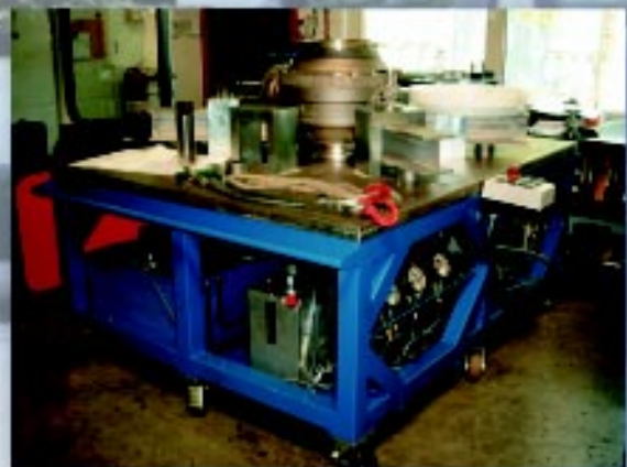
Prüftisch für Kugelhähne bis DN 500 und 80 bar Prüfdruck Test bench for Ball valves up to 20" and pressure up to 1160 psi
