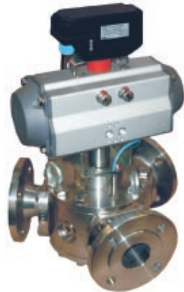
Bild 1 - 3-Wege Molchweiche in Stern-Ausführung mit Schwenkantrieb BR 31a
