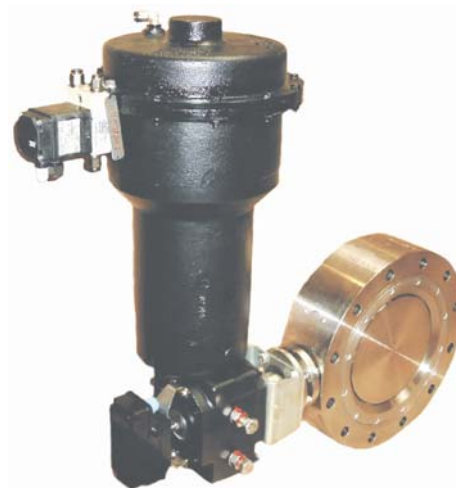
Изображение 2 – мембранный поворотный привод BR 30a с регулирующей заслонкой 14a и встроенным позиционером
